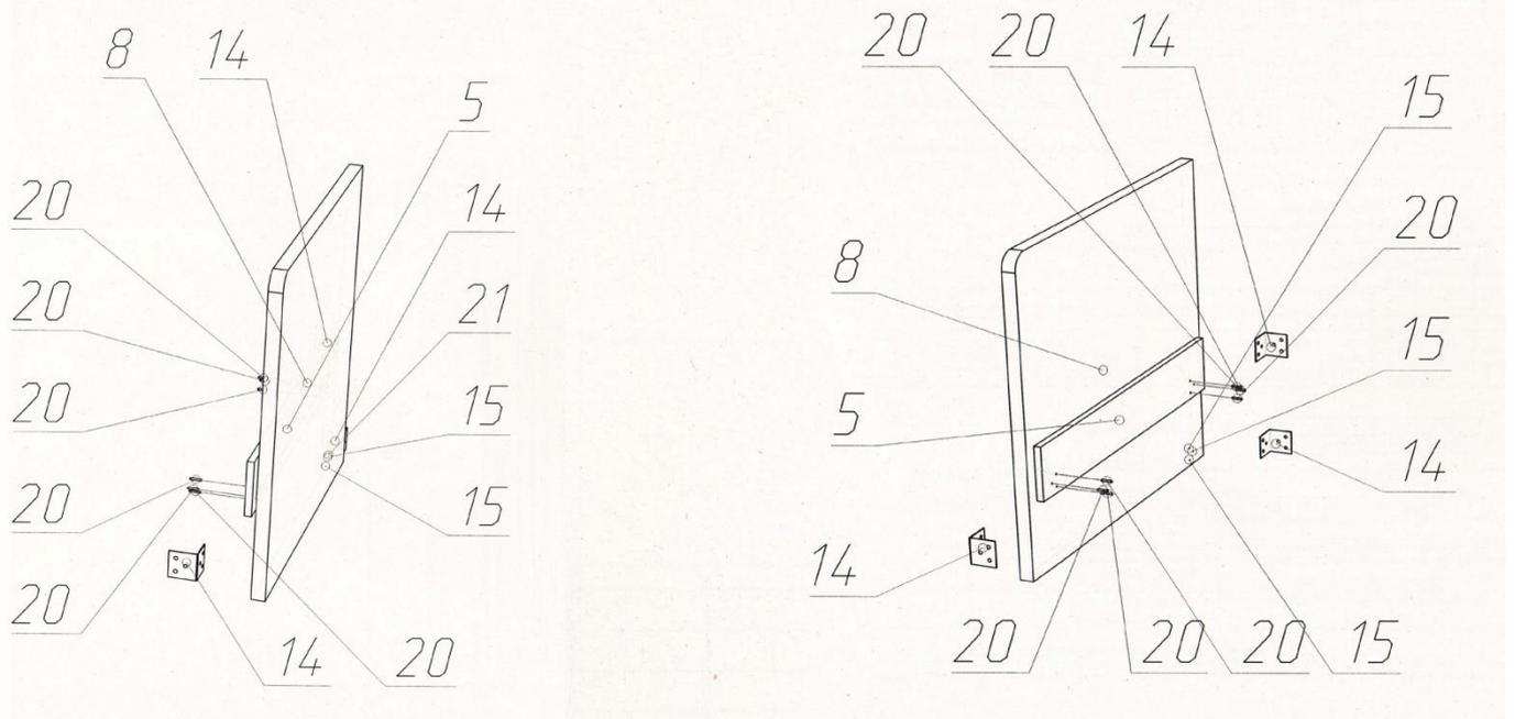
2.3) Соедините боковины со спинкой дивана. Для этого положите спинку на пол задней стороной. Возьмите плоскую деталь из ЛДСП, на неё приложите уже собранное изделие в п. 2.1, сопоставьте отверстия. Возьмите поочередно боковины от дивана и скрепите всё винтами М6х65. Нижние уголки закрепите винтами М6х35. Передними уголками прикрутите мягкий фасад дивана, используя винты М6х35. Сделайте контрольную протяжку всех винтов.
